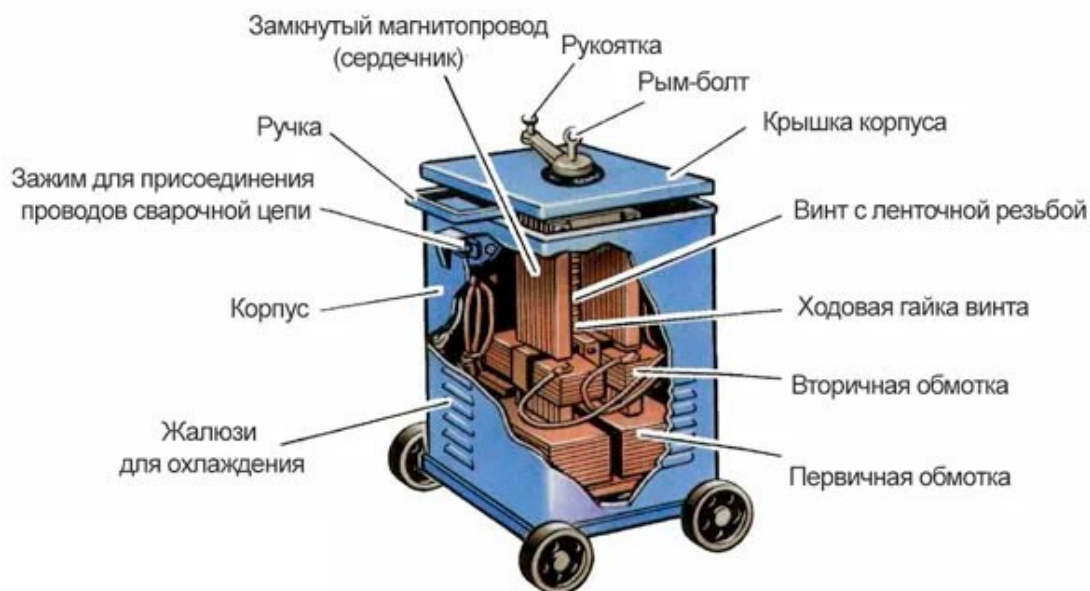
Рисунок 4 – Устройство сварочного трансформатора
